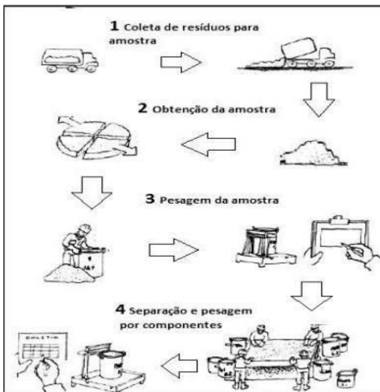
Figura 1 - Método de quarteamento para realizar a análise da amostra.
